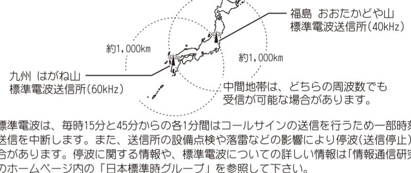
●標準電波は、毎時15分と45分からの各1分間はコールサインの送信を行うため一部時刻情報の送信を中断します。また、送信所の設備点検や落雷などの影響により停波(送信停止)する場合があります。停波に関する情報や、標準電波についての詳しい情報は「情報通信研究機構」のホームページ内の「日本標準時グループ」を参照して下さい。
